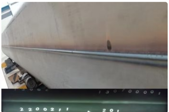
*주요 용접부 형상 및 방사선(RT) 검사 결과
